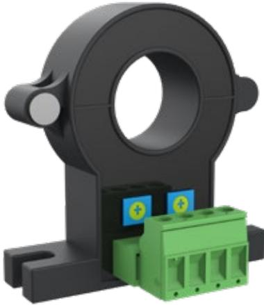
I sensori serie QI-HSC permettono la misura di correnti continue e alternate con ottima precisione ed ampio range di misura. La loro installazione risulta agevolata grazie al nucleo apribile (collegamento immediato, senza scollegare i conduttori) e dall'impiego di morsettiere a vite estraibili.
