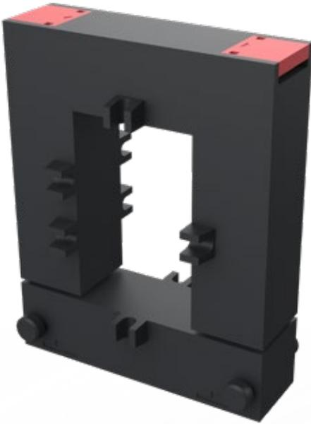
Trasformatore amperometrico apribile con secondario a 5A, classe 1, foro 20x30mm / 50x80mm / 80x120mm / 80x160mm.
