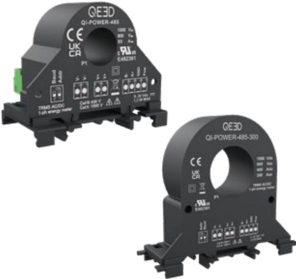
Il QI-POWER-485 (nelle sue 3 taglie di corrente 50, 100 e 300A) è un analizzatore di rete monofase con misura diretta della corrente sia AC (TRMS) che DC e dell'energia senza l'ausilio di TA esterni.
